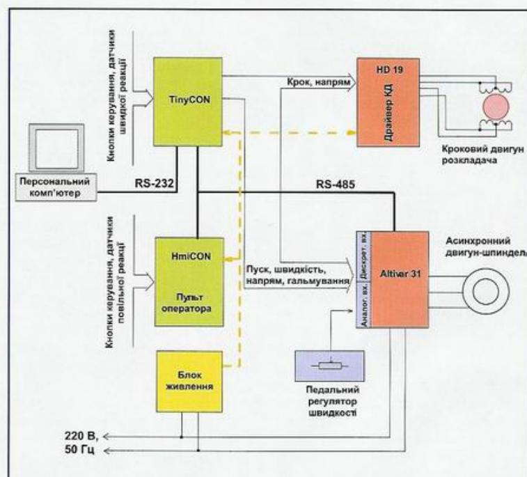
реакції, заведені на порт дискретних входів пульта оператора hmiCOM. Через вихідний порт дискретних сигналів контролер генерує керуючі сигнали на обидва привода основних вузлів верстата - шпіндель і розкладач.
