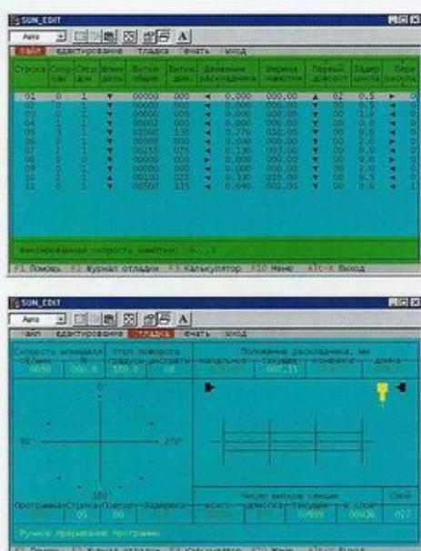
В склад поставки вестату входить програма роботи верстата "sun-18.exe" і спеціалізована програма редактор "sun\_edit.exe", призначена для підготовки, редагування, емуляції намотки катушки на персональному комп'ютері.
